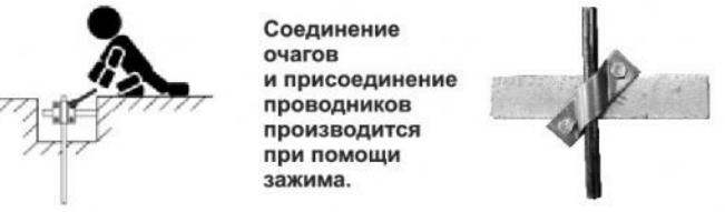
Соединение очагов и присоединение проводников производится при помощи зажима.
