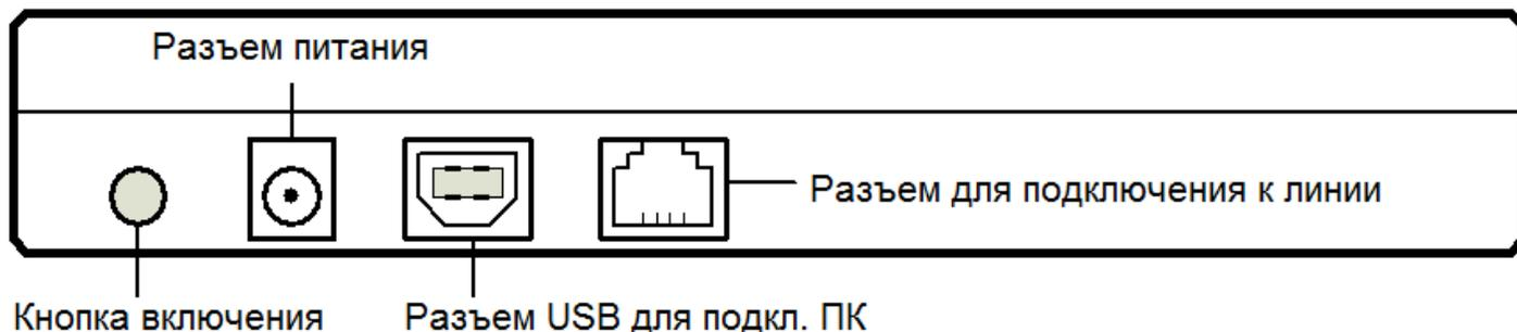
На задней панели расположены кнопка включения / выключения тестера, разъем для подключения к тестеру сетевого адаптера (он же источник для зарядки аккумулятора), USB разъем для подключения тестера к персональному компьютеру, разъем для подключения тестера к испытываемой линии.
